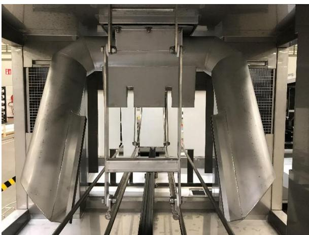
désiré. Les couteaux et canaux d'air en acier inoxydable directement reliés au ventilateur sont conçus de manière à obtenir un flux d'air fluide avec un minimum de chute de pression et une performance maximale. Le concept de séchage est basé sur la recirculation de l'air, chauffant l'air à environ 30°C. Entre le tunnel de lavage et le module de séchage, une zone de séparation est installée pour éviter les perturbations.
