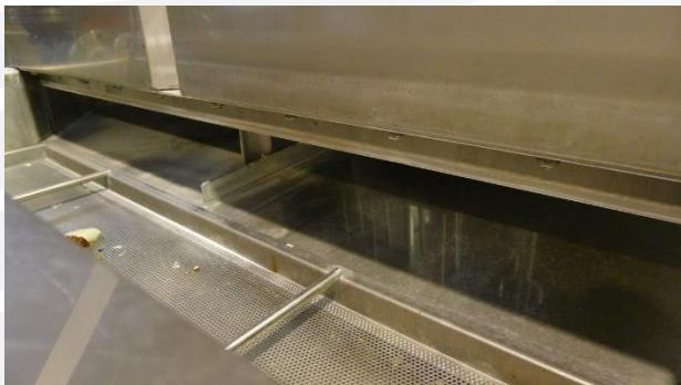
La laveuse pour chariots Cretel est équipée de façon standard d'un filtre statique qui est manuellement amovible à des fins de nettoyage.
