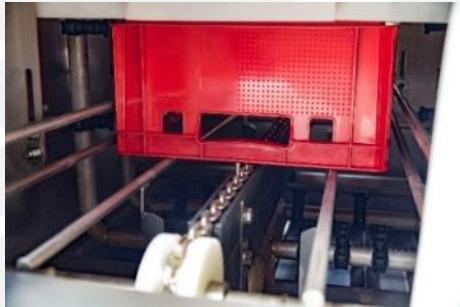
La vitesse du transport est réglable de telle sorte à ce que le temps de contact des articles dans le tunnel puisse être prolongé ou raccourci. Toutefois, le degré de salissage doit être pris en compte. Une augmentation excessive de la vitesse diminuera le résultat du lavage.
