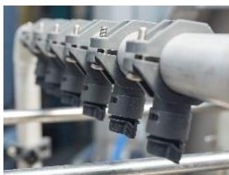
Le système de pulvérisation est constitué de buses plates qui peuvent être détachées facilement. Le motif de pulvérisation est orienté spécifiquement en fonction de l'application.
