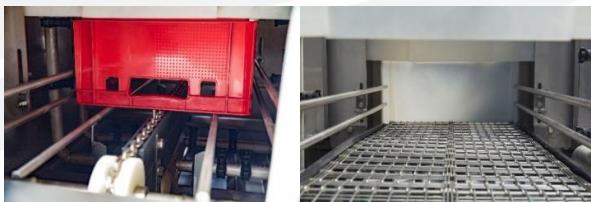
La vitesse du transport est réglable, de telle sorte à ce que le temps de contact des articles dans le tunnel puisse être prolongé ou raccourci. Toutefois, le degré de salissage doit être pris en compte. Une augmentation excessive de la vitesse diminuera le résultat du lavage.
