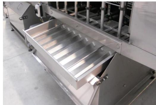
Le tunnel de lavage Cretel est équipé de façon standard d'un filtre statique manuellement amovible pour un entretien facile. La laveuse est conçue pour créer une capacité de filtrage maximale, même en cas de salissage intensif.
