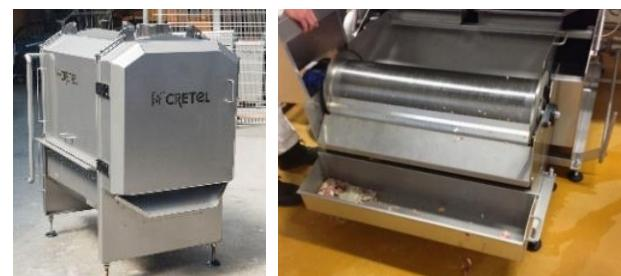
En option, le tunnel de lavage peut être équipé d'un filtre rotatif (système Auger or Slit) en cas de salissage extrêmement intensif.
